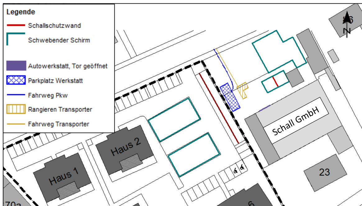
Abbildung 7 – Lage der Schallquellen (Autowerkstatt)
