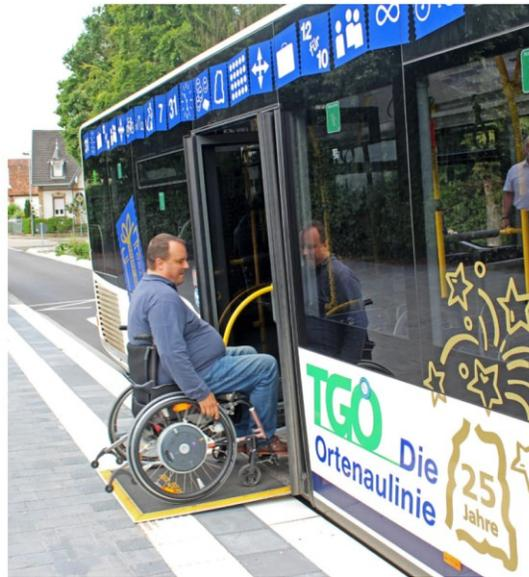
Linienführung des Fahrbahnrandes so, dass Spaltmaß „Bus/Bordstein“ 5-10 cm
