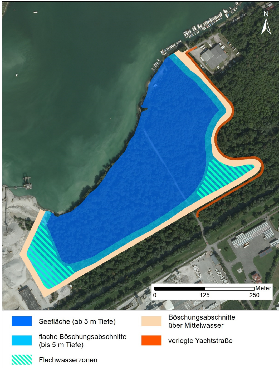
Abbildung 4.1-1. Geplante Seefläche bei Mittelwasser, geplante Flachwasserzonen und flache Böschungsabschnitte in der Erweiterungsfläche und zukünftiger Verlauf der Yachtstraße.
